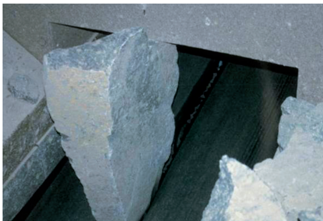
Esempio di rottura di un nastro
