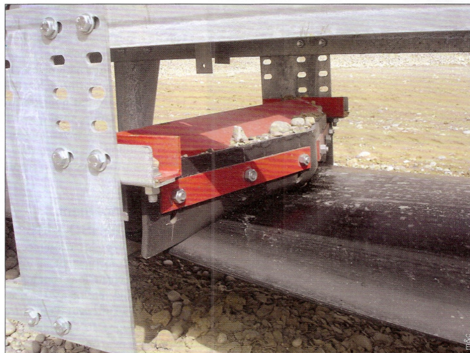
Les racleurs de bande accentuent les craquelures en diminuant l'adhérence du caoutchouc
