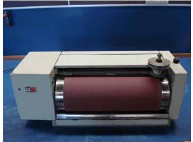
ISO /DIN Máquina de ensayos de abrasión
