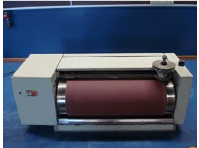
Apparecchiatura per il test di abrasione ISO/DIN
