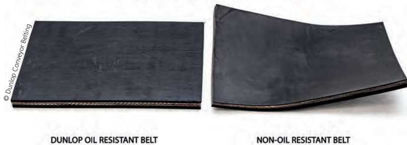
→ Échantillons de bande suivant l'essai à l'huile.
