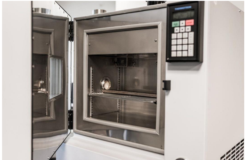
Las muestras de cinta se congelan mediante nitrógeno líquido
