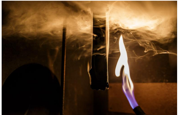
Prueba de resistencia al fuego ISO 340
