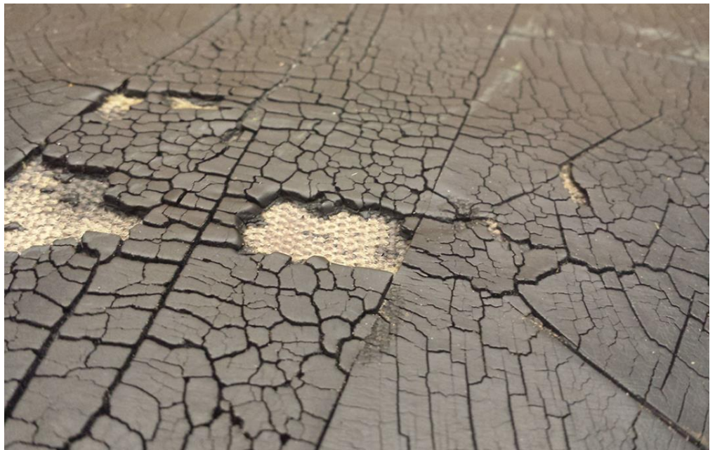
Skutki uszkodzeń termicznych
