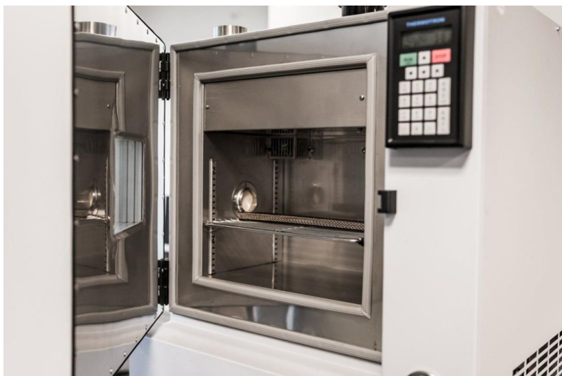
Próbki taśmy zamraża przy użyciu ciekłego azotu
