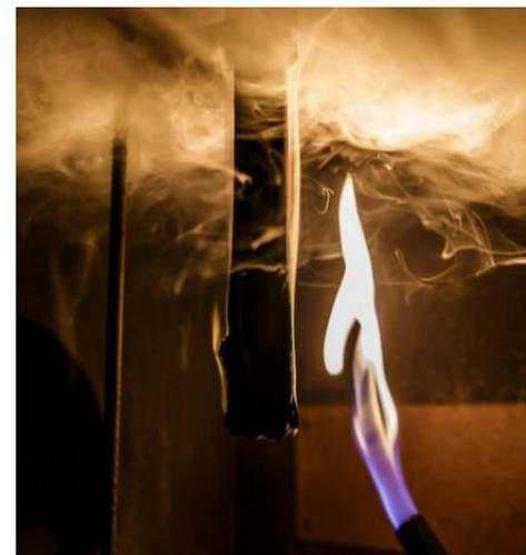
Ensayo de resistencia al fuego ISO 340
