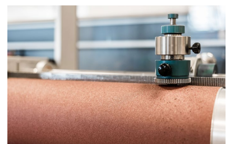
ISO 4649 / DIN 53516 abrasion testing
