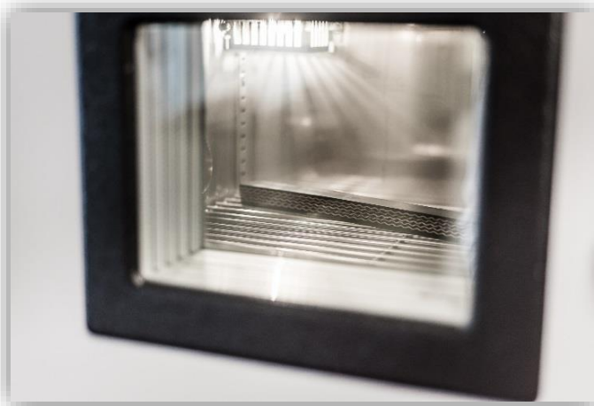
I CAMPIONI DI GOMMA VENGONO CONGELATI CON AZOTO LIQUIDO
