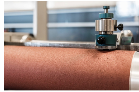
ISO 4649 / DIN 53516 abrasion testing
