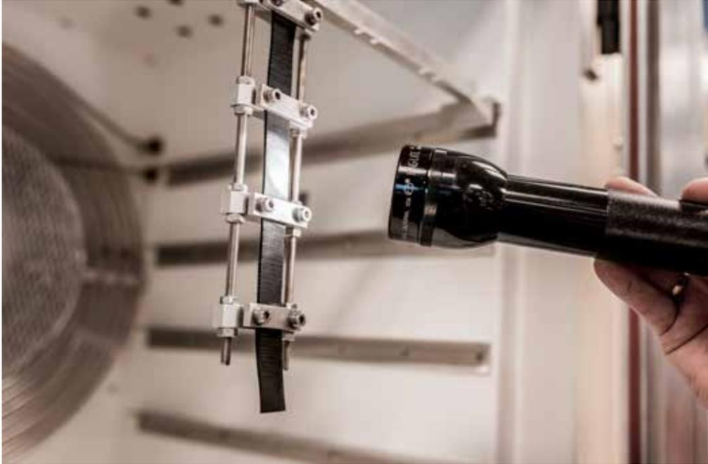
7 Die Proben werden alle zwei Stunden auf Risse untersucht
