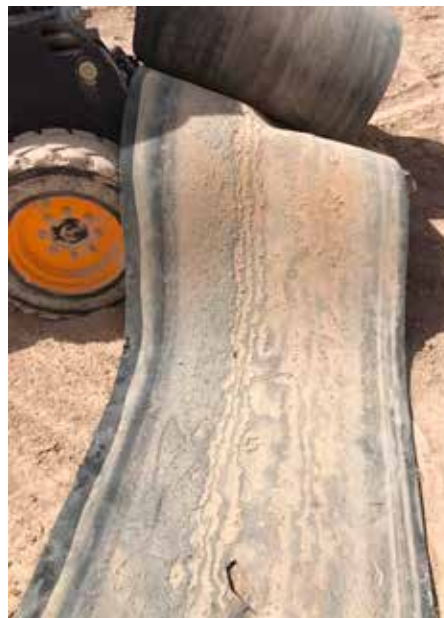
4 Die Verschleißfestigkeit von Gummi ist eine Kombination aus Gesamtfestigkeit, Abriebfestigkeit und Widerstand gegen Schnitt- und Rissfortpflanzung
