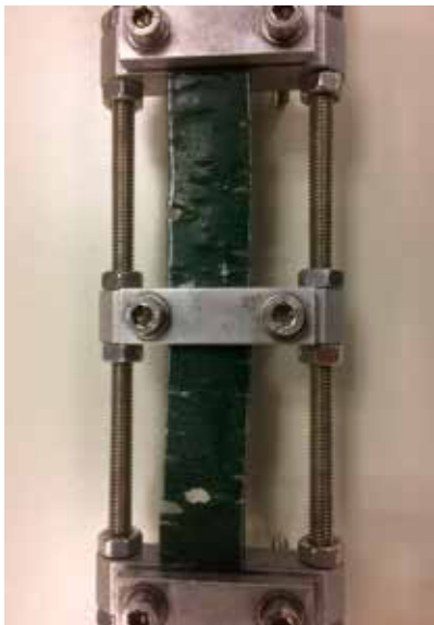
5 Ozon und ultraviolettes Licht führen dazu, dass sich Gummi buchstäblich auflöst Ozone & ultra violet light causes rubber to literally disintegrate
