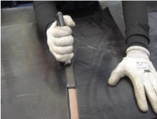
Bild 4. Entfernen des Deckstreifen
