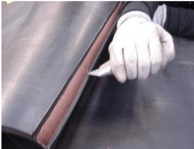
Bild 5. Einschneiden durch die Gewebelage
