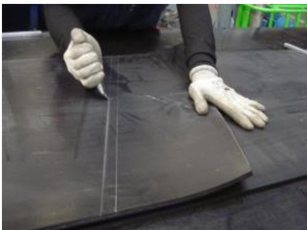
Fotografía 3. Corte en un ángulo de 45°
