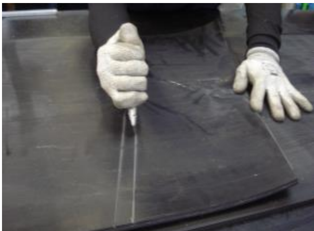
Fotografía 2. Corte de la tira de relleno
