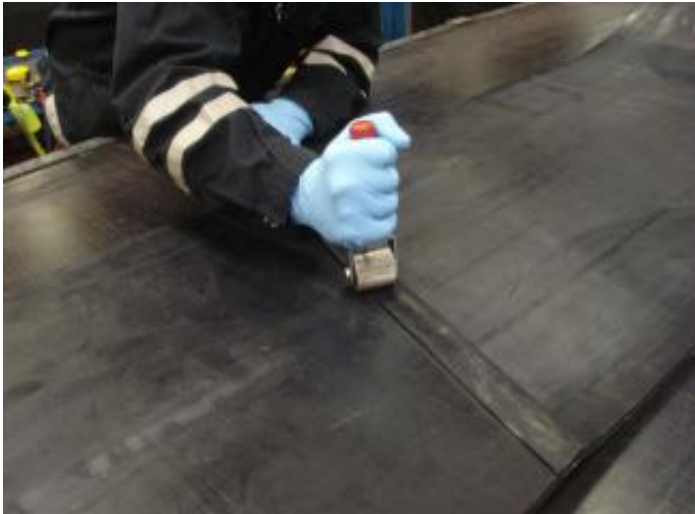
Fotografía 15. Inserte la tira de relleno
