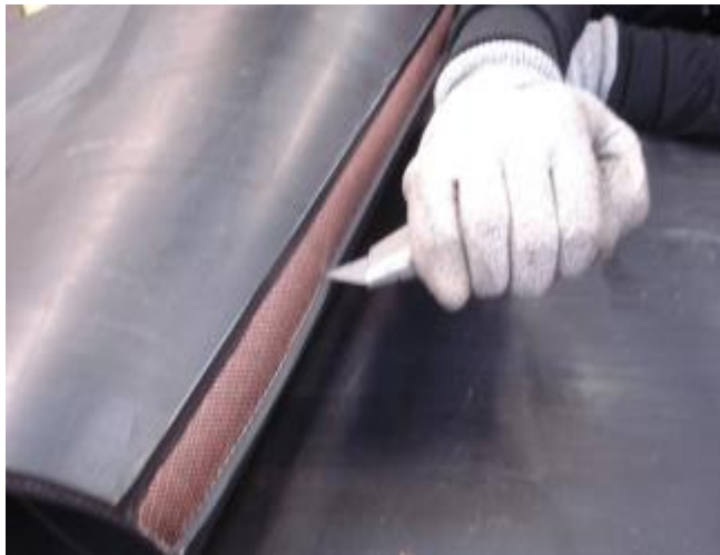
Fotografía 5. Cortar las capas de tejido
