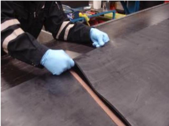
Aligner les deux extrémités de la bande et les joindre avec précision. Les deux extrémités doivent s'emboîter exactement.
