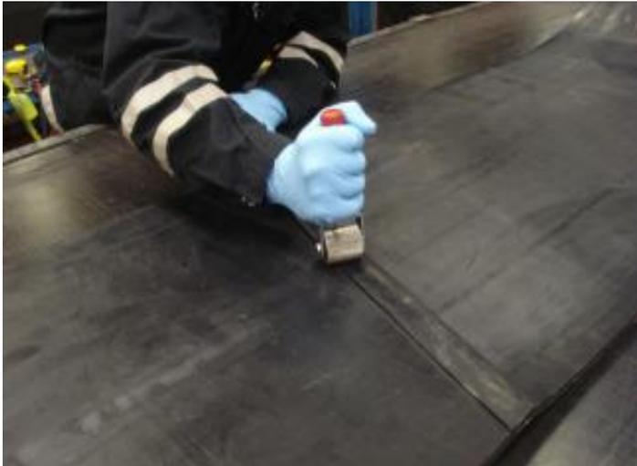
Mettre en place une couche de gomme de liaison Dunlofol et l'épaisseur de Duncover nécessaire et rouler fortement afin d'éviter les bulles d'air.
