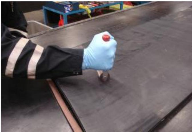
Afin d'éviter les bulles d'air, bien rouler la jonction, du centre vers l'extérieur pour expulser l'air.
