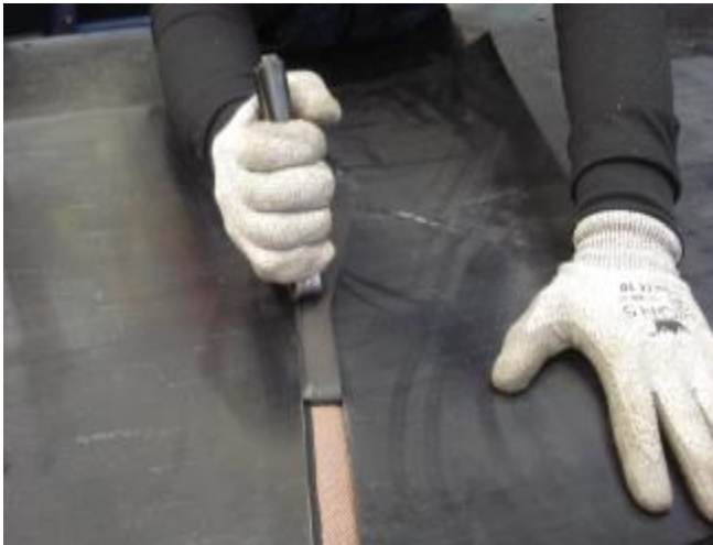
Zdjęcie 4. Odrywanie gumy okładkowej
