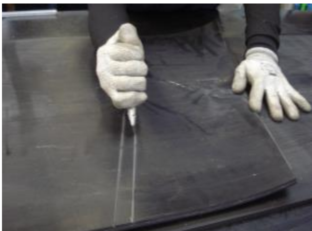
Zdjęcie 2. Wycinanie paska wypełniającego
