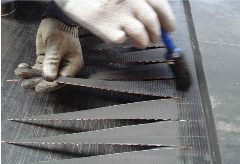
Aplica la solución a los dedos a ambos finales de la banda sobre el lado de la cobertura inferior.
