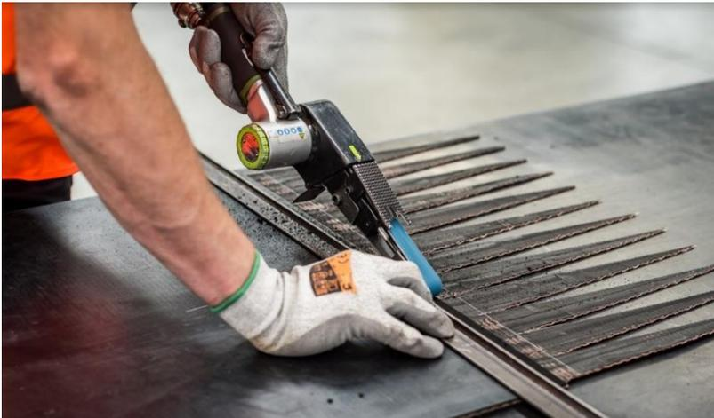
Bisela la inclinación de 45° y la cobertura a un ancho de 30 mm superior e inferior.
