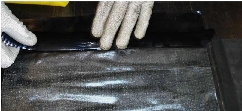
Aplica Duncover para los bordes de la banda. Espesor igual a: Espesor carcasa + 3 mm
