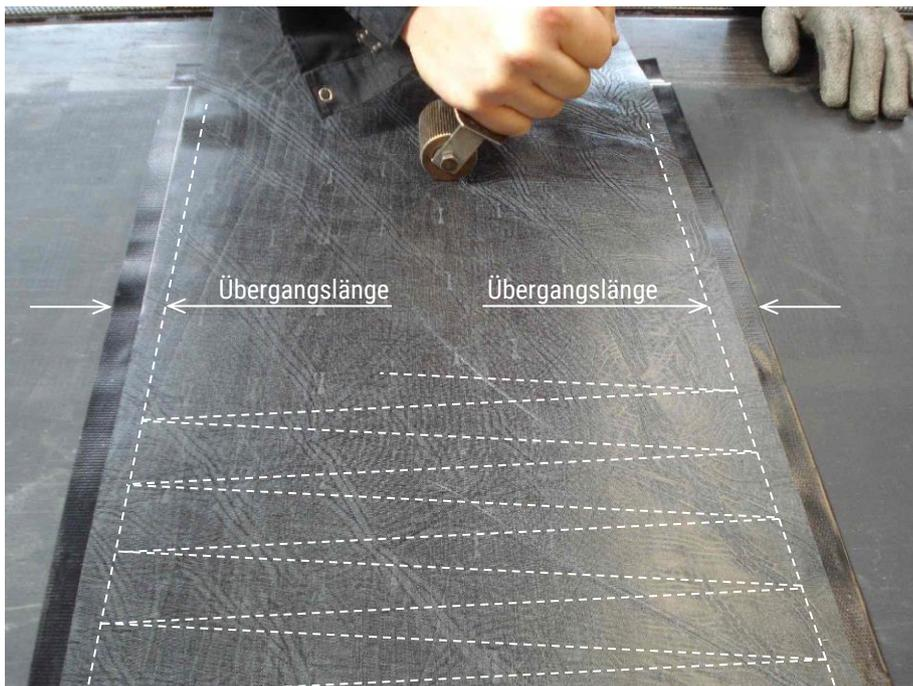
Das gummierte Gewebe auf das erforderliche Maß schneiden. Gummiertes Gewebe auf der Deckplatte positionieren. Es soll zur Hälfte den Bereich der Übergangslänge überdecken. Das Gewebe sollte in einer Länge so vorbereitet werden, dass es die Finger sowohl im oberen als auch in der unteren Abdeckung umgibt. Unterdecke und gummiertes Gewebe fest anrollen. Die Folie im Randbereich des Gurtes auf dem Gewebe lassen, damit es vor dem Wickeln nicht an der Decke klebt (siehe Bild 24/25).
