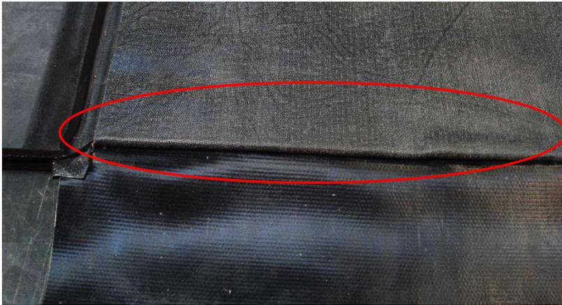
Das gummierte Gewebe dicht um die Gurtkante ziehen.
