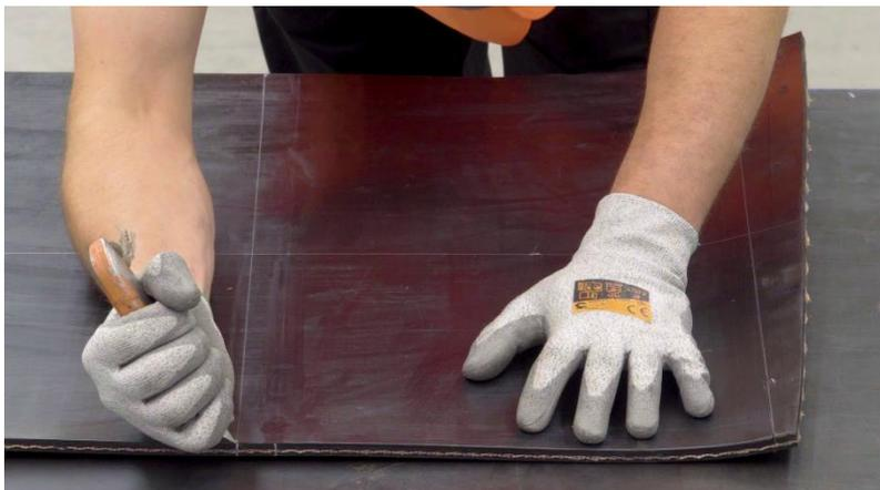
Die Decke muss unter einem Winkel von wenigstens 45° angeschnitten werden.
