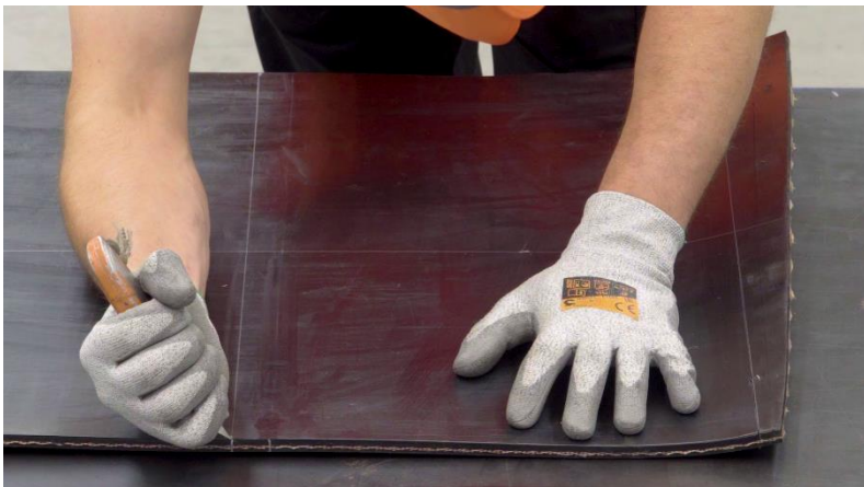
Bild 2: Schneiden unter einem Winkel von wenigstens 45°
