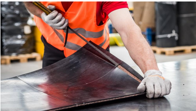
Bild 3: Einschneiden der Decke und Entfernen der Deckstreifen
