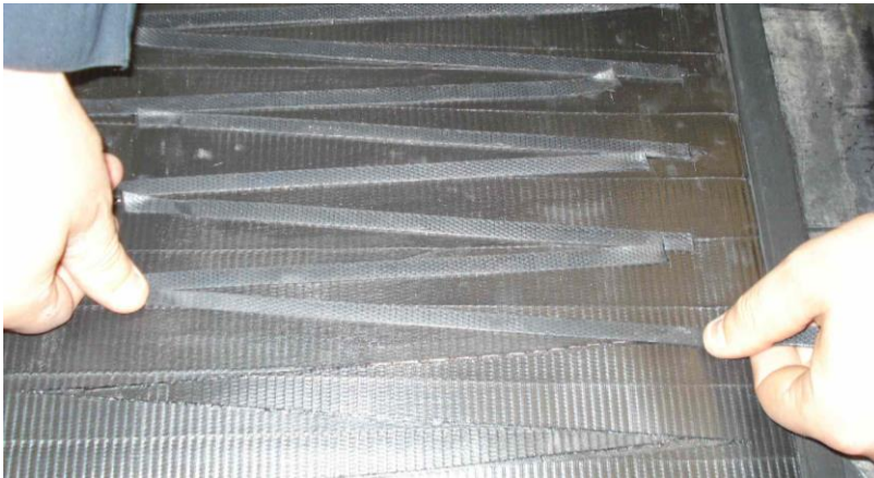
Bild 24: Gummistreifen zwischen den Fingern anbringen
