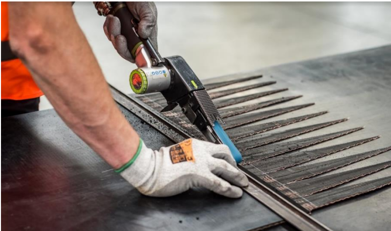
Bild 10: Schleifen der Decken
