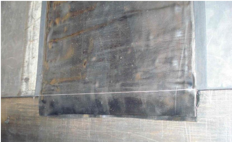
Bild 27: Markierung der Gurtkanten
