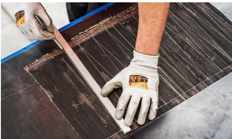
Bild 8: Schneiden der Finger
