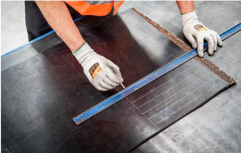
Bild 4: Die Fingerbreiten aufzeichnen
