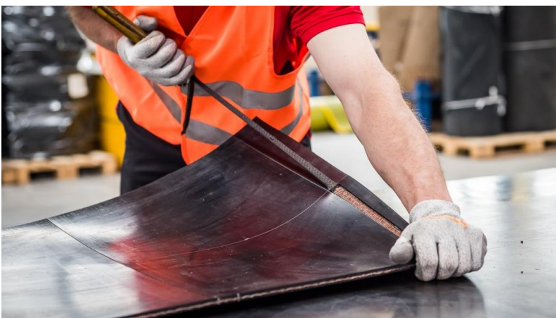
Foto 3: Cortando la cobertura y retirando la tira
