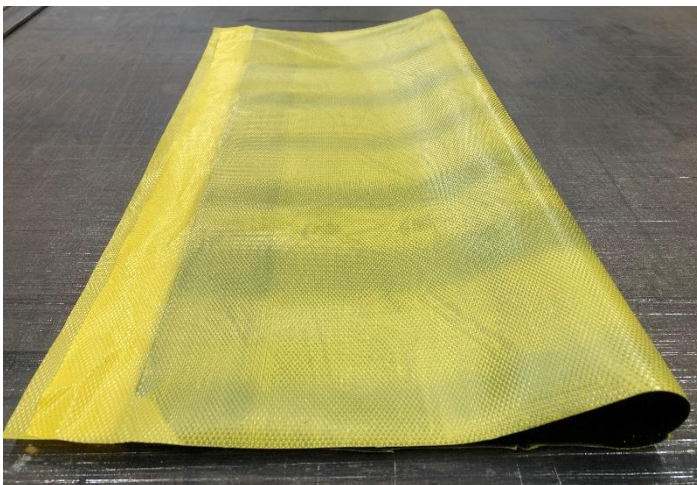
Foto 16: Prepare 2 capas de caucho de adhesión de carcasa
