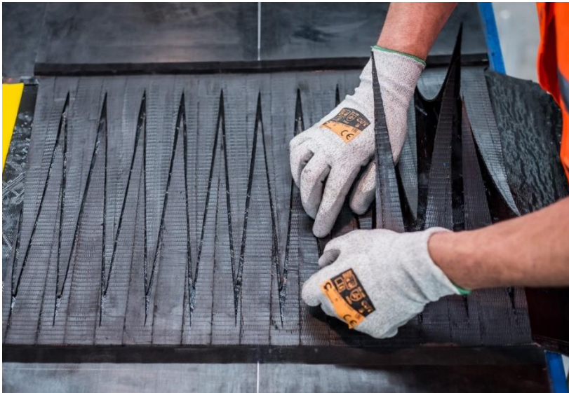
Foto 21: Positioneren van beide bandhelften
