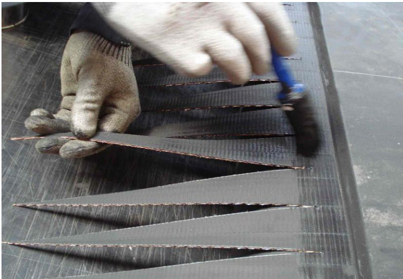
Foto 18: Solutie op de onderzijde van de vingers
