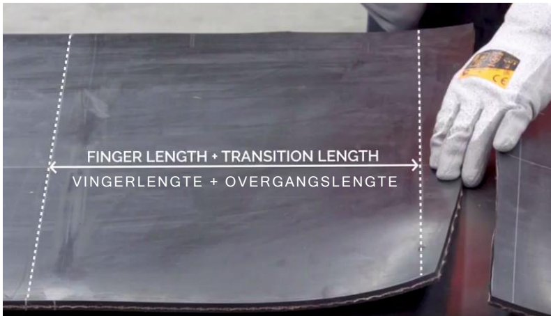
Foto 1: Markeren van de deklaag
