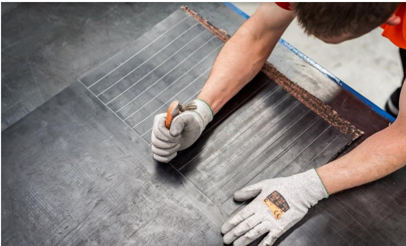
Foto 5: Snijden van de deklaag
