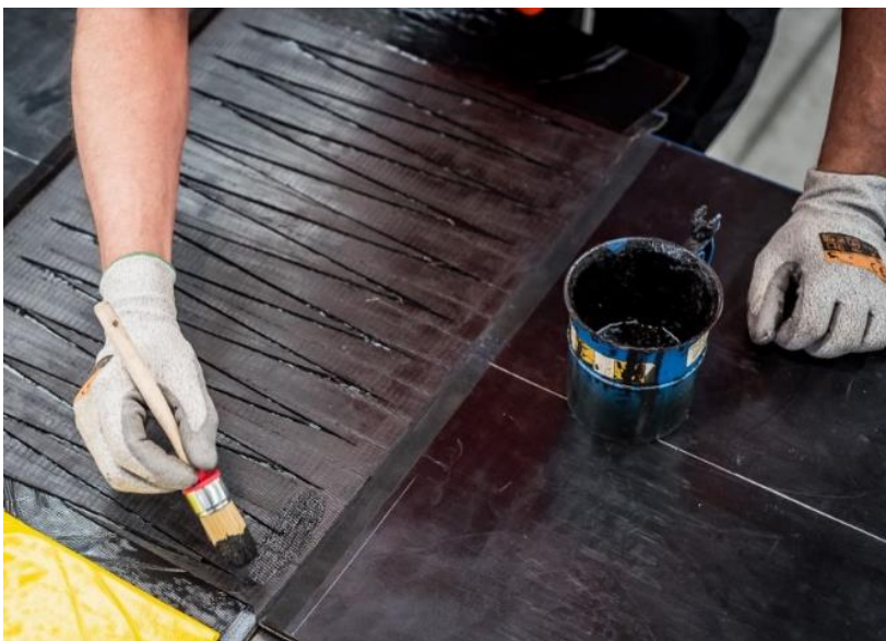
Foto 23: Solutioneren van de bovenkant van de vingers
