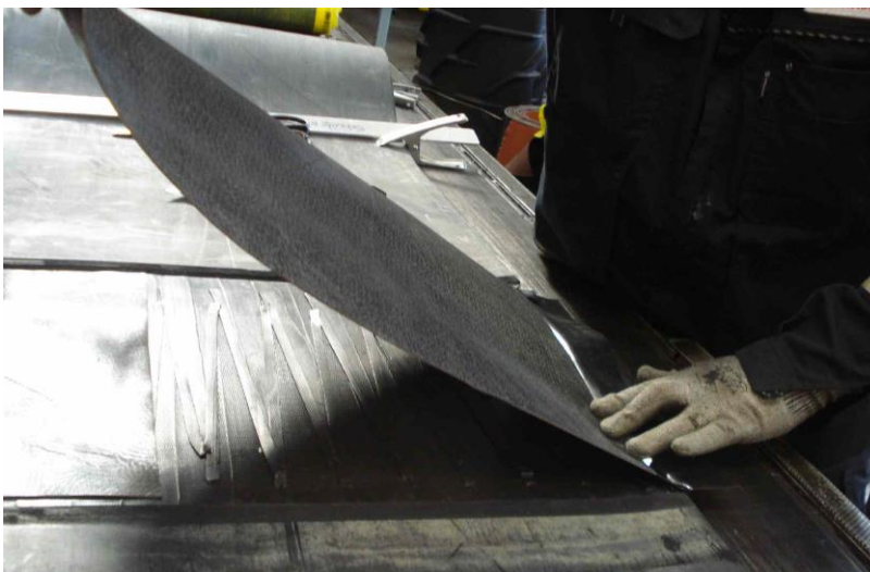
Bild 24: Gewebe um die Karkasse wickeln
