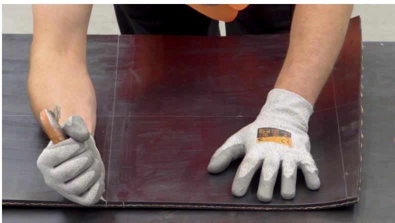
Bild 2: Schneiden unter einem Winkel von wenigstens 45°
