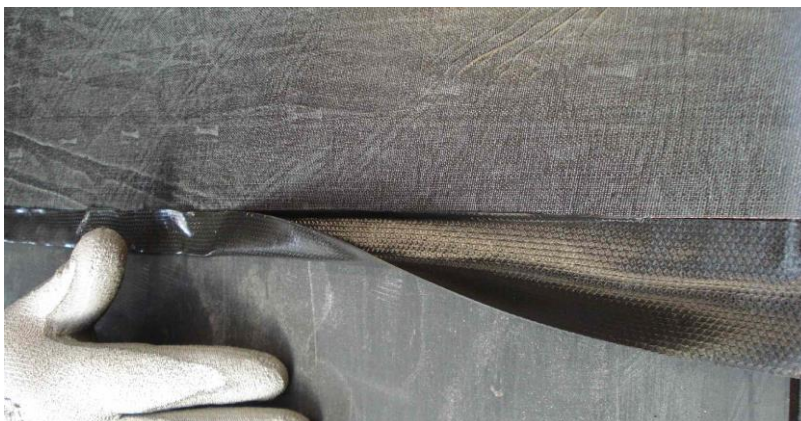
Bild 18: Eine zweite Lage Dunlofol neben dem Gewebe anbringen
