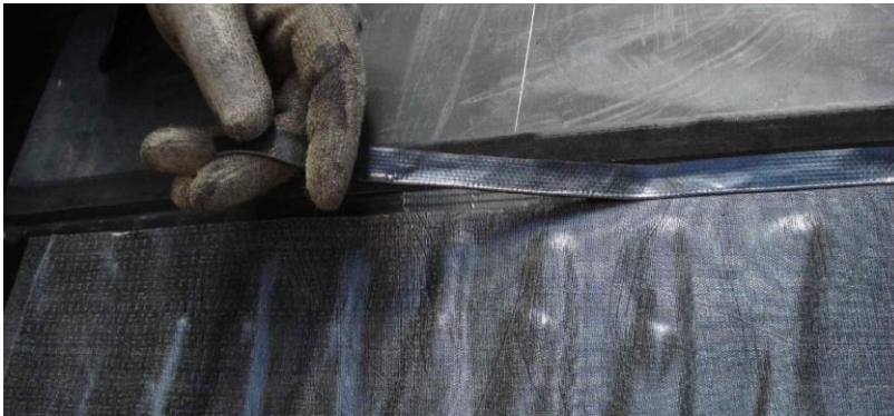
Bild 28: Dunlofol neben das gummierte Gewebe
